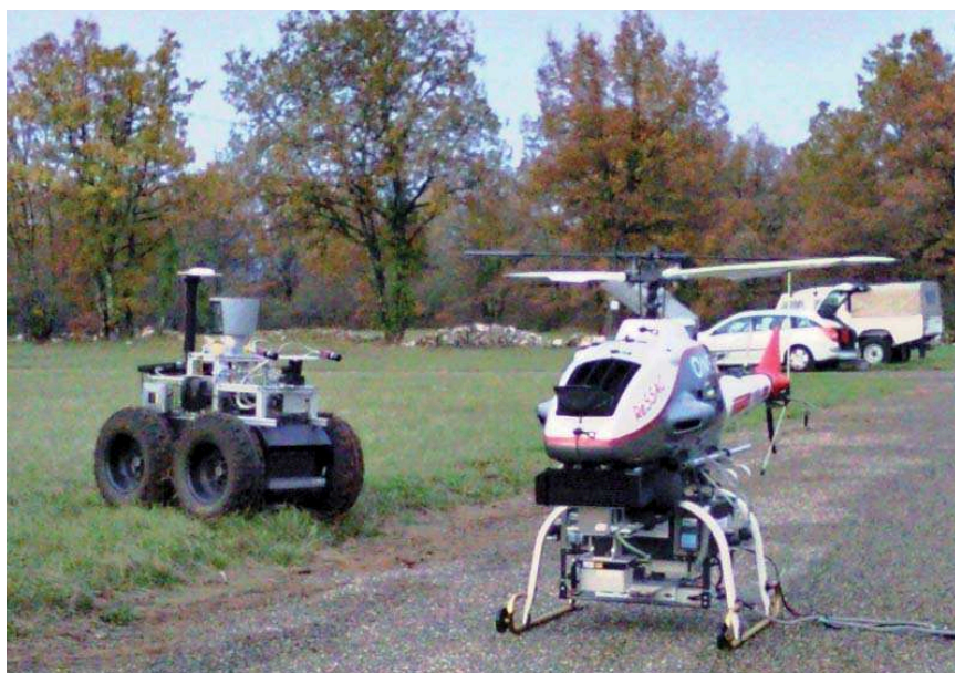
Le robot terrestre Mana du Laas et l'hélicoptère Ressac de l'Onera. Ces robots sont exploités dans des expérimentations de contrôle de zone menées dans le contexte du PEA Action supporté par la DGA (action. onera.fr). Il s'agit d'explorer une zone pour y détecter et localiser une cible mobile, puis d'assurer son suivi.
